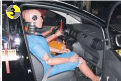
Assim que o carro fica preparado •, ele é posicionado para o crash test. Para simular um motorista e um passageiro, colocamos bonecos nos bancos do condutor 2 e do carona 3. Por todo corpo do boneco, inclusive na face, pinturas 4 indicam possíveis danos que podem ocorrer após o choque. Para simular um outro carro de mesma característica ao que irá se chocar, coloca-se um bloco de alumínio 3. O carro vai em direcão do bloco para se chocar de frente 3.
